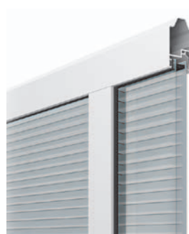
OPALPOLYKARBONAT MED IHÅLIG KÄRNA Light transmittance 42% K = 1,7 W/m 2 K
