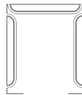
HR41R/HR53 (EN 81-70) Rör med invikta ändar
